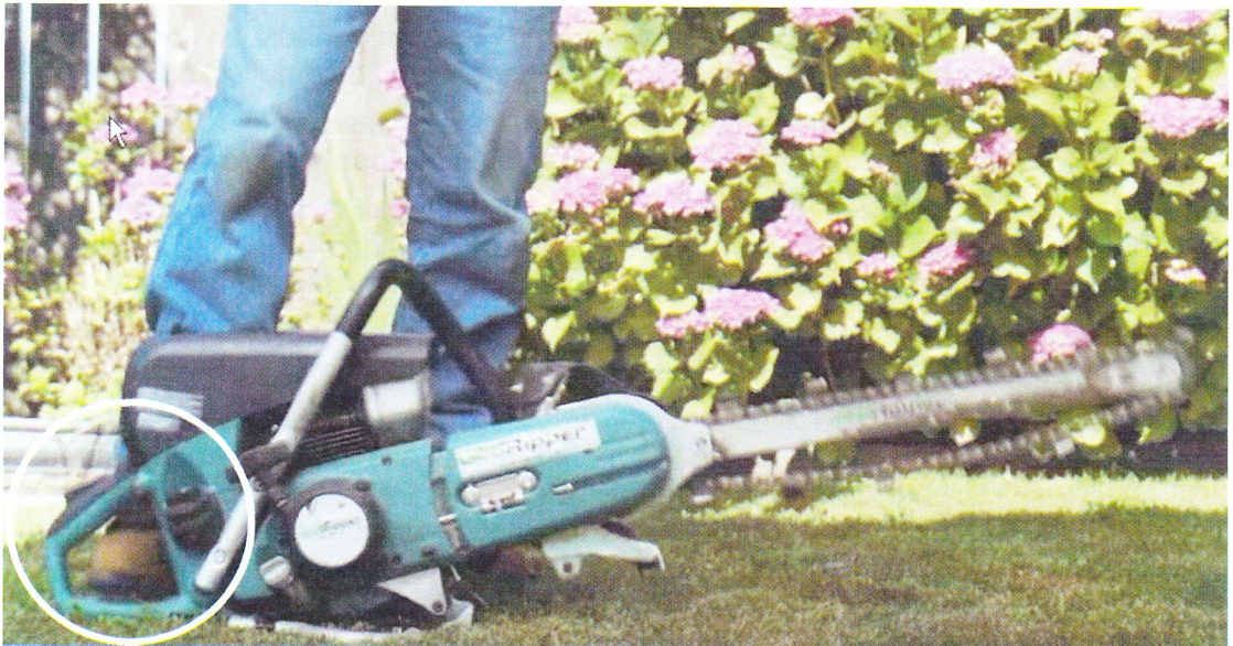
Rys. 51: Prawidłowe uruchomienie silnika napędowego koparki łańcuchowej GeoRipper®.
