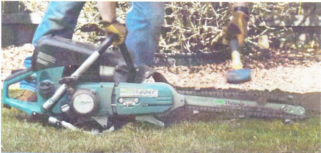
Rys 56: Usuwanie kamieni z łańcucha kopiącego
