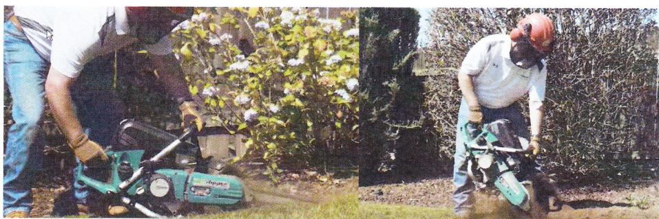
Rys. 53: Koparka GeoRipper® wbijana w podłoże
