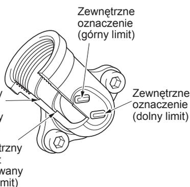
Rys. 2 Rurka olejowa
