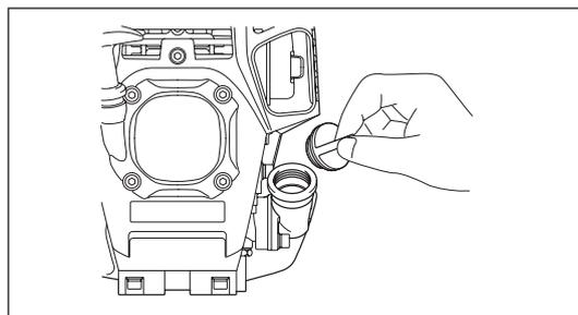
(2) Naplňte olejom po značku hornej hranice. (pozrite si Obr. 3)
