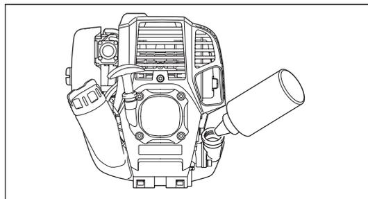
(3) Bezpečne utiahnite uzáver olejovej nádrže. Nedostatočné utiahnutie môže spôsobiť unikanie oleja.
