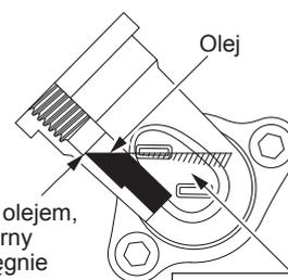
Napełniać olejem, aż jego górny poziom sięgnie elementu wewnętrznego stopniowanego (górny limit).
